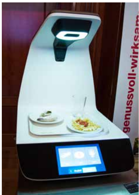
„Trayzi“ scannt und erkennt die Speisen auf dem Tablett.
